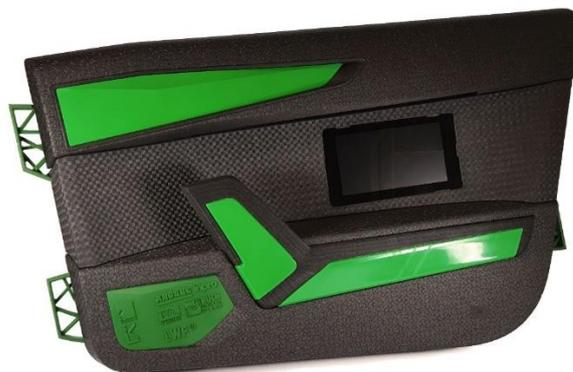
Konzept einer Fahrzeugtür-Innenverkleidung aus dem Projekt „SamPa“<sup>13</sup>
